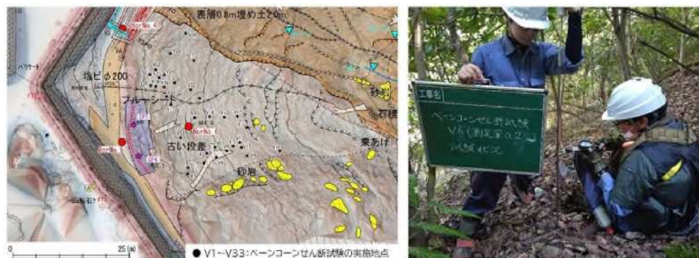
図-2 B箇所斜面内における試験実施地点（左）および試験実施状況（右）
